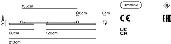
Anschluss: Direktanschluss / Einbauleuchte
