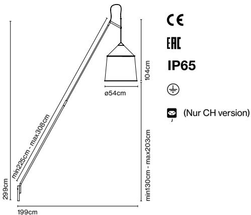
Kabellänge: min 2 m - max 2,8 m
